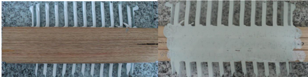
Pegado Parquet sobre vidrio: vista frente (izq) vista atrás (der)
