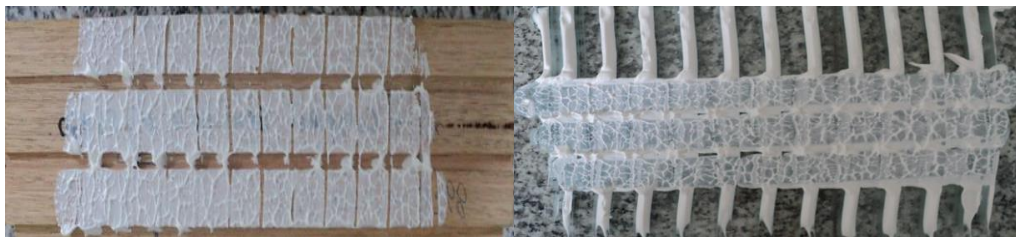
Mojado correcto del adhesivo sobre parquet (izq) sobre vidrio (der) visto de atrás.
